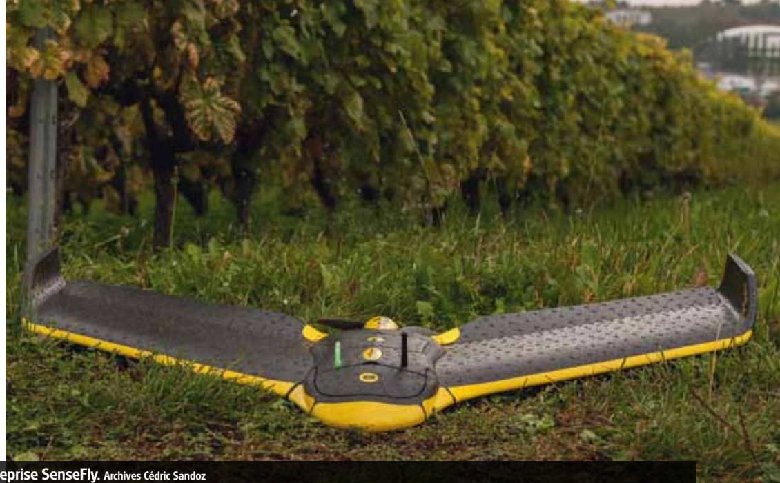
Drone cartographeur de terrain de l'entreprise SenseFly. Archives Cédric Sandoz
